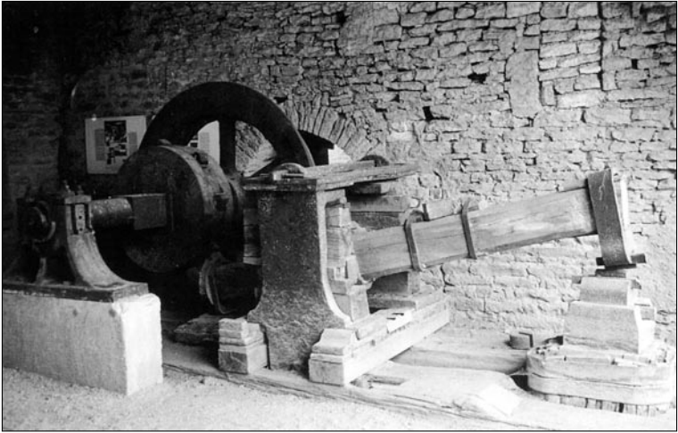
Die Schmiede von Buffon ist heute noch weitgehend im Originalzustand erhalten. Im Bild: Schmiedehammer.
